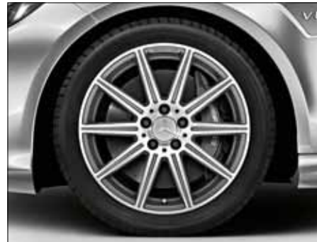
Легкосплавные диски AMG с 10 спицами, полированные, шины 255/35 R 19 впереди и 285/30 R 19 сзади (код 796 3 или 797 4 ).
