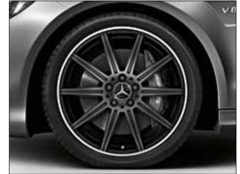
Легкосплавные диски AMG с 10 спицами, матовая черная лакировка, полированный обод, шины 255/35 R 19 впереди и 285/30 R 19 сзади (опция для моделей AMG, код 752).
