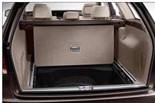
Складной пол багажного отделения EASY-PACK открывается частями.
