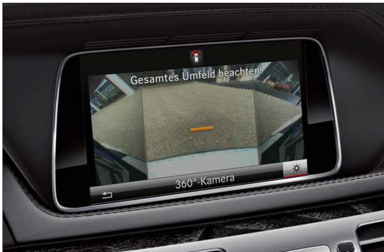
Виртуальная видеокамера с круговым обзором создает изображение автомобиля и его окружения.
