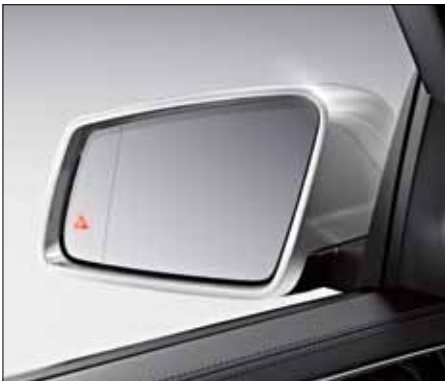
Система мониторинга «мертвых зон» (визуальный сигнал).
