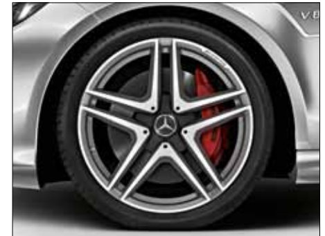
Кованые диски AMG с 5 двоянными спицами, лакировка «Серый титан», полированные, шины 255/35 R 19 впереди и 285/30 R 19 сзади (опция для моделей AMG, код 785).
