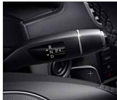
Селектор DIRECT SELECT (в сочетании с АКП 7G-TRONIC PLUS и 9G-TRONIC).
